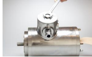
Das Anschlusskabel und die Aderendhülse müssen für Temperaturen bis 120 °C geeignet sein. Bereiten Sie die Ausläufer der Motorwicklung für die richtige Verbindung Y bzw. Δ entsprechend dem Motortypenschild vor. Die rot/schwarz markierten Drähte sind für die PTC. Die gelb markierten Drähte sind für die Bimetalle.
