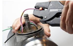
Das Netzkabel muss fest in der Kabelverschraubung sitzen. Die Jacke muss in die Stopfbuchse eingespannt werden, um einen guten Schutz gegen Feuchtigkeit zu erhalten.
