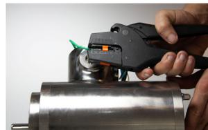
Führen Sie das Kabel durch eine geeignete Kabelverschraubung aus Edelstahl in den Klemmenkasten. Im Beispiel wurde eine Kabelverschraubung aus Edelstahl verwendet.
