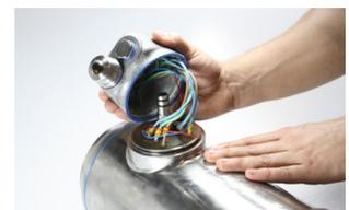
Setzen Sie die Befestigungsschraube in den Mittelstift ein und ziehen Sie die fest an. Die O-Ringe bieten ausreichenden Schutz gegen das Eindringen von Feuchtigkeit, die blauen Hygienerringe sorgen für eine hygienische Abdichtung.
