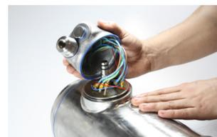
Inserte el perno de montaje en el pasador central y apriete firmemente.
