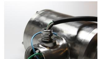
Conecte las salidas de devanado y los cables del motor con uniones calientes aptas conforme al esquema de conexiones.
