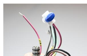
Engrase ligeramente la junta tórica y el anillo higiénico azul. Engrase las juntas tóricas del pasador de montaje central. Coloque la tapa de la caja de terminales sobre la clavija de montaje central y asegúrese de que el prensaestopas esté colocado de manera que el prensaestopas quede hacia abajo. Tome el perno de montaje, engrase el anillo sanitario azul y colóquelo alrededor del perno de montaje.
