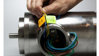
Entfernen Sie sorgfältig die Isolierung des Erdungskabels und sorgen Sie dafür, dass eine für das verwendete Kabel geeignete Kabelöse mit entsprechendem Durchmesser vorhanden ist. Versehen Sie das Erdungskabel mit einer Kabelöse. Befestigen Sie die Kabelöse am Erdungskabel.
