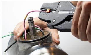
Das Netzkabel muss fest in der Kabelverschraubung sitzen. Die Jacke muss in die Stopfbuchse eingespannt werden, um einen guten Schutz gegen Feuchtigkeit zu erhalten.
