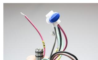
Fetten Sie den O-Ring und den blauen Hygienering leicht ein. Fetten Sie die O-Ringen an der zentraler Befestigungsstift. Setzen Sie die Klemmenkastenabdeckung über den zentralen Befestigungsstift und stellen Sie sicher, dass die Kabelverschraubung so positioniert ist, dass die Kabelverschraubung nach unten zeigt. Nehmen Sie die Befestigungsschraube, fetten Sie den blauen Hygienering ein und legen Sie ihn um die Befestigungsschraube.
