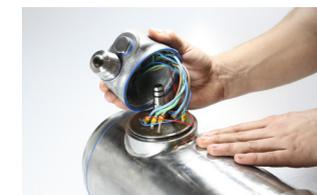
Setzen Sie die Befestigungsschraube in den Mittelstift ein und ziehen Sie die fest an. Die O-Ringe bieten ausreichenden Schutz gegen das Eindringen von Feuchtigkeit, die blauen Hygieneringe sorgen für eine hygienische Abdichtung.
